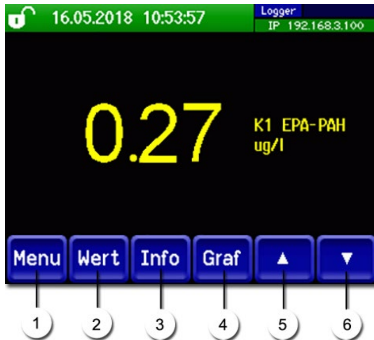
Abbildung 22: Bedienelemente im Messbetrieb
