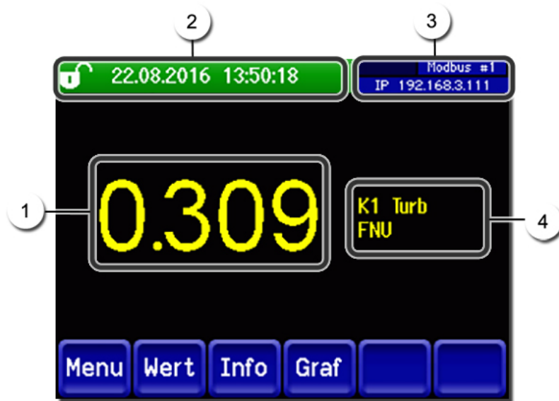
Abbildung 27: Anzeigen im Messbetrieb
