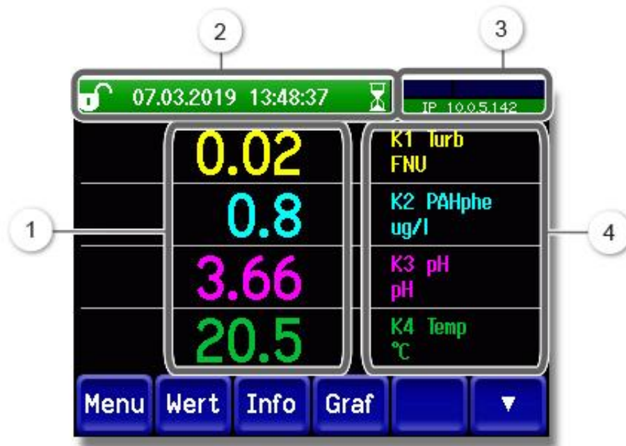
Abbildung 24: Anzeigen im Messbetrieb
